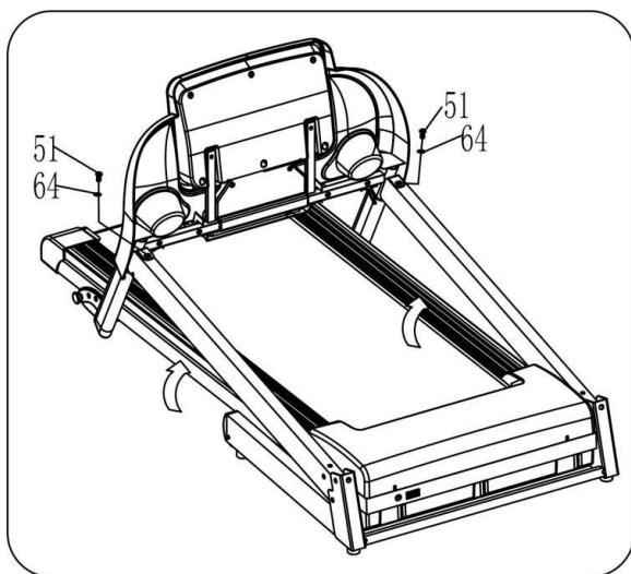
1. Удерживайте раму компьютера и используйте шестигранный ключ 5# (12), болт (51) и замочную шайбу (64), чтобы зафиксировать раму компьютера на правой и левой стойках.
