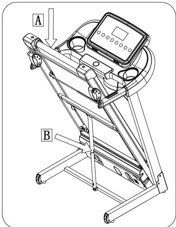
Поднимайте опорную раму до положения (A), пока не услышите, что подпорка (B) зафиксировалась на круглой трубке.
