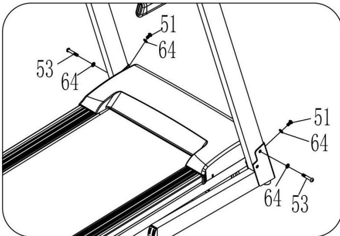
1. Используйте шестигранный ключ 5# (12) , сначала зафиксируйте стойку на основании с помощью болта (53) и замочной шайбы (64), а затем зафиксируйте стойку на основании с помощью болта (51) и замочной шайбы (64).
